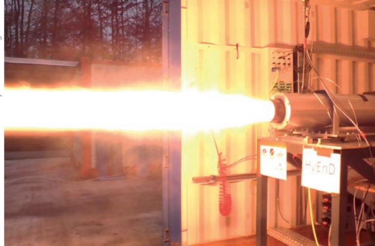
Auf dem Testfeld 11.5 des DLR-Instituts für Raumfahrtantriebe in Lampoldshausen wurde das Triebwerk der HEROS-Rakete getestet
