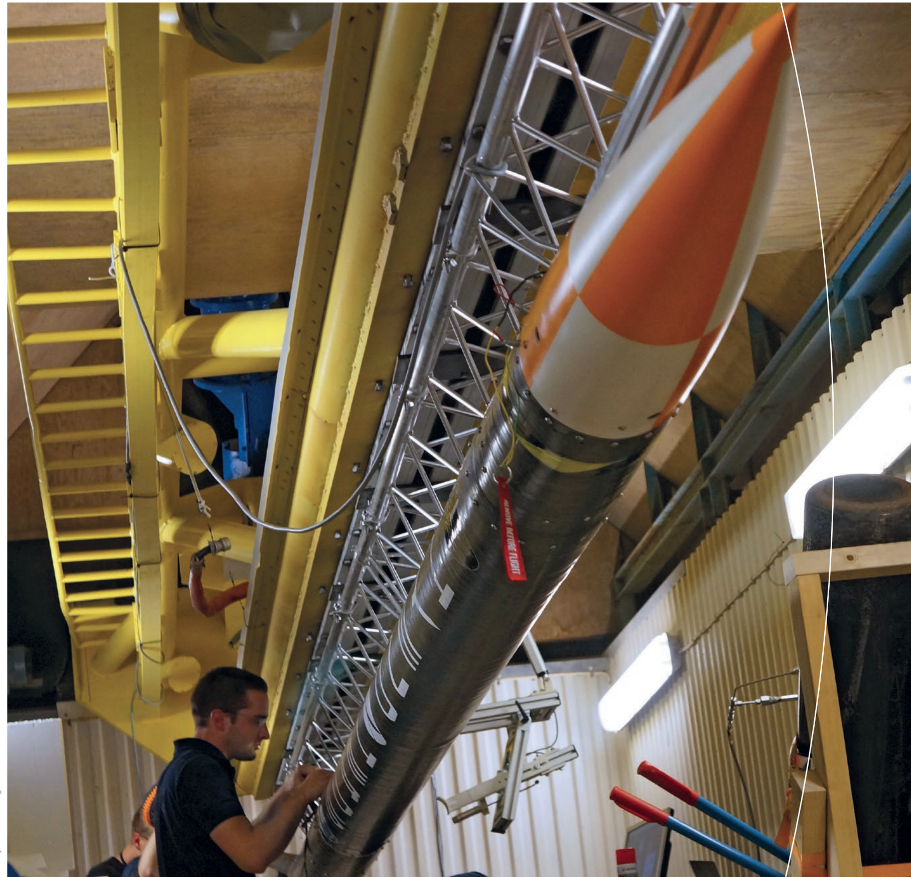
Montage der HEROS-Rakete an die Führungsschiene der Startrampe auf Esrange
